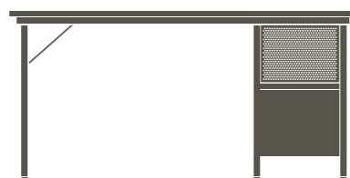
Eames Desk Unit EDU, Charles & Ray Eames, 1949 Hauteur : 740 mm Plateau de table : 1525 x 710 mm
